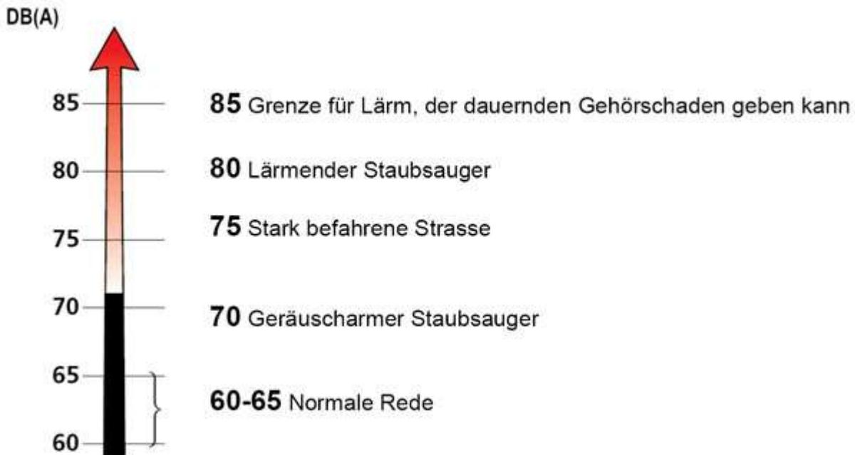
**Gemäß der Maschinendirektive 2006/ 42/EF dürfen Maschinen nicht mehr als 80dB(A) lärmern.**
