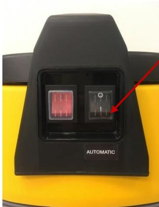
Die Ein-/und Ausschaltautomatik wird mit dem schwarzen Schalter am Motorkopf ein- und ausgeschaltet. Wenn die Ein-/und Ausschaltautomatik betätigt ist, schaltet die Maschine nicht ein, wenn man auf den roten Schalter drückt. Die Maschine wird nicht eingeschaltet, bevor das angeschlossene Handwerkzeug eingeschaltet wird.
