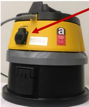
Das elektrische Handwerkzeug wird an den Stromabgriff hinten am Motorkopf angeschlossen.
