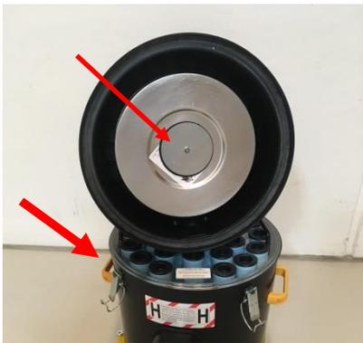
Die vier Behälterklammern, die den Motorkopf festhalten, lösen, und den Motorkopf abheben. Den Motorkopf so anbringen, dass zum Filter Zutritt ist.
