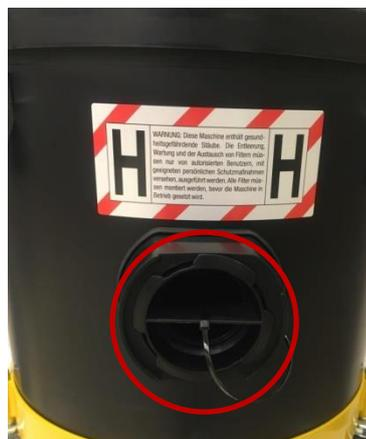
Der Behälter ist mit einem Stopfen versehen, den beim Transport und Stillstand der Maschine verwendet werden muss.
